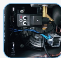
♦ DRENO AUTOMÁTICO SISTEMA ACOPLADO COM PURGADOR ELETRÔNICO
